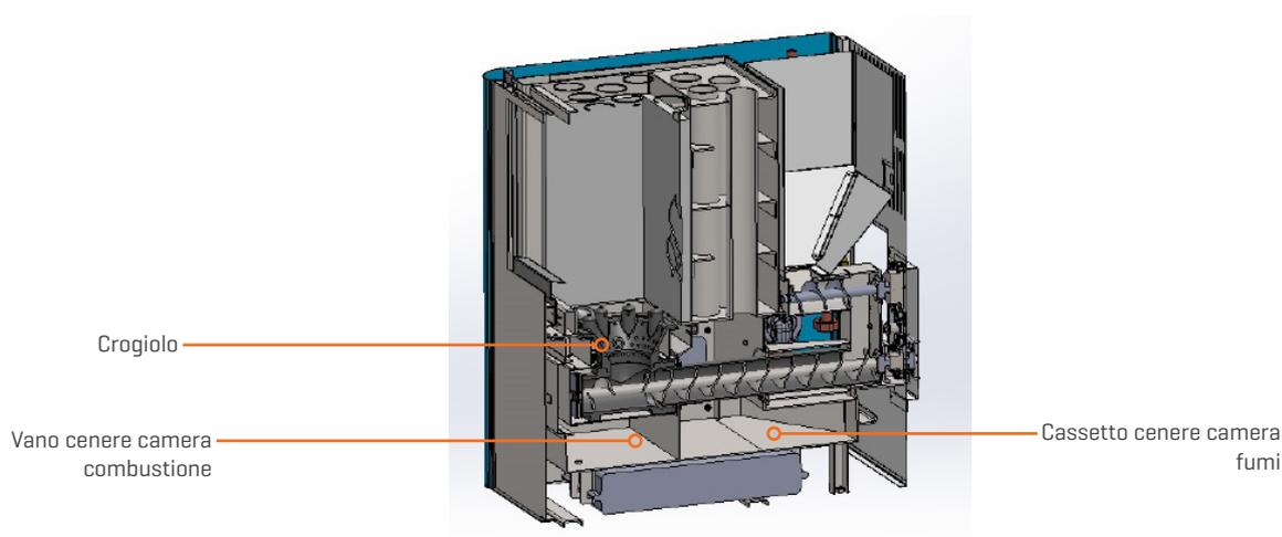
Nota. In funzione della qualità del biomassa in termini di residuo catramoso, procedere alla rimozione del crogiolo per la pulizia nella zona sottostante ad esso.
