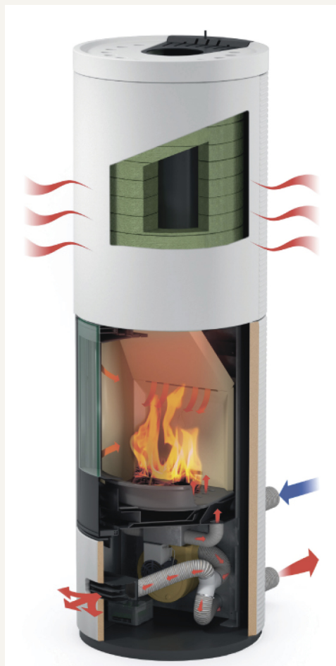
Схема роботи системи. Ілюстрація технології BCS.
